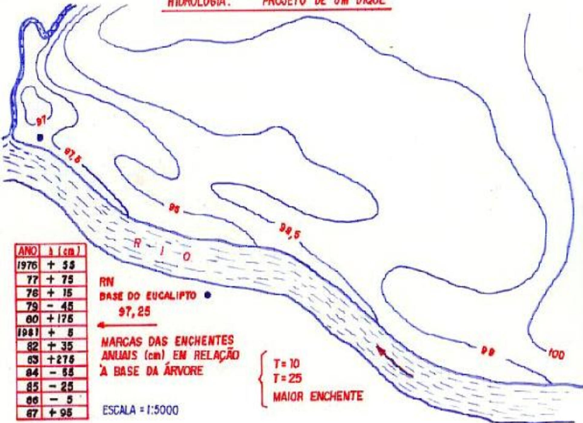
Exemplo: Estimar a altura de um dique a partir de registros de cheias máximas anuais de um rio em relação à cota (RN = 97,25 m) situada na base de uma árvore, localizada na parte mais baixa de uma várzea.
