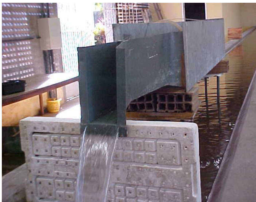
Figura 2. Sistema para calibração de calhas Parshall
