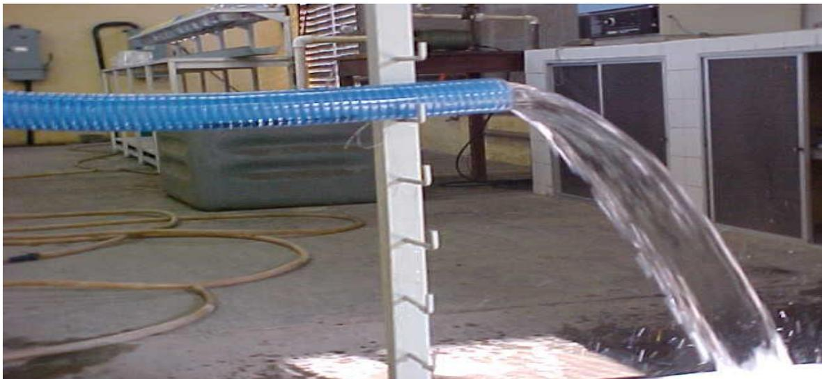
**Figura 05.** Procedimento para calibração de sifões em laboratório
