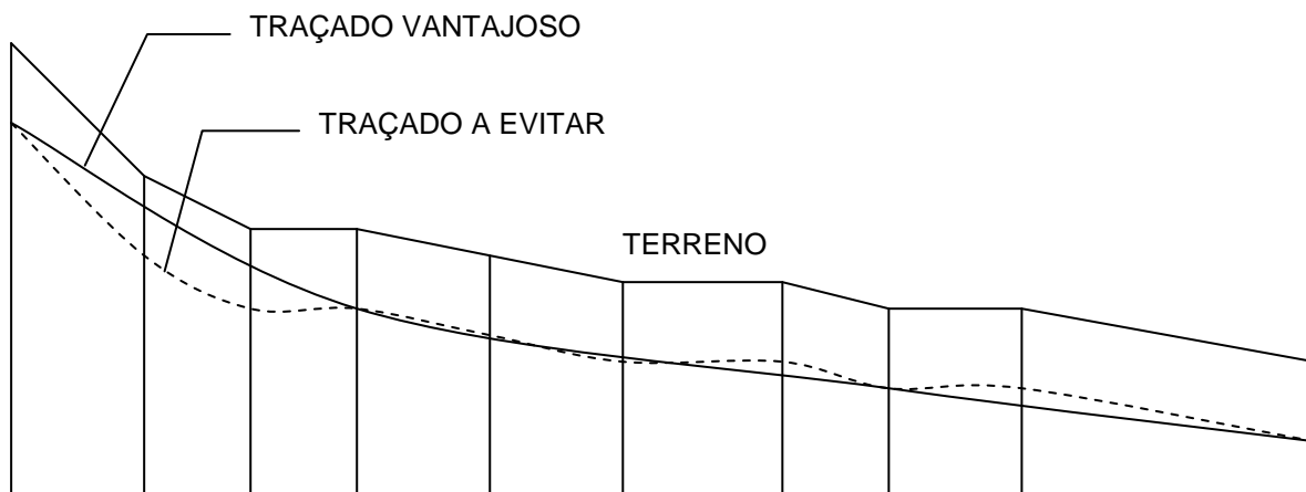
Figura 03. Ilustração de traçado vantajoso e traçado a evitar
