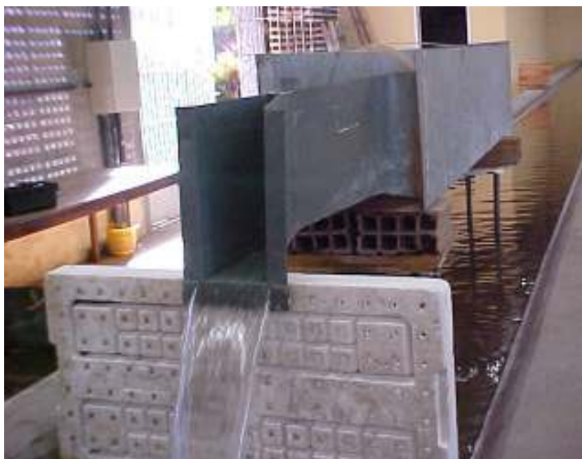
Figura 2. Sistema para calibração de calhas Parshall
