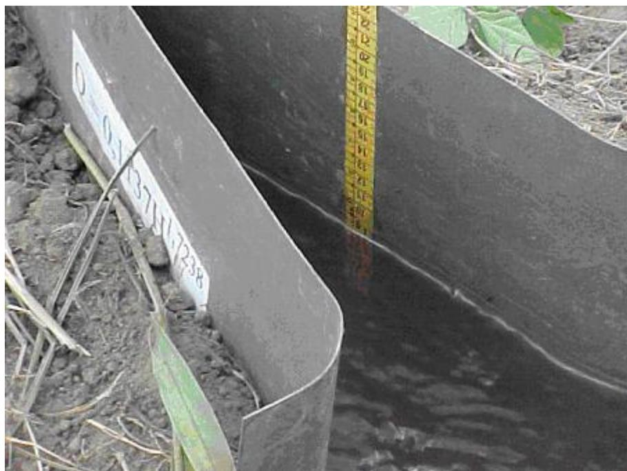
. **Fig. 4.** Medição de água através de calha Parshall.
