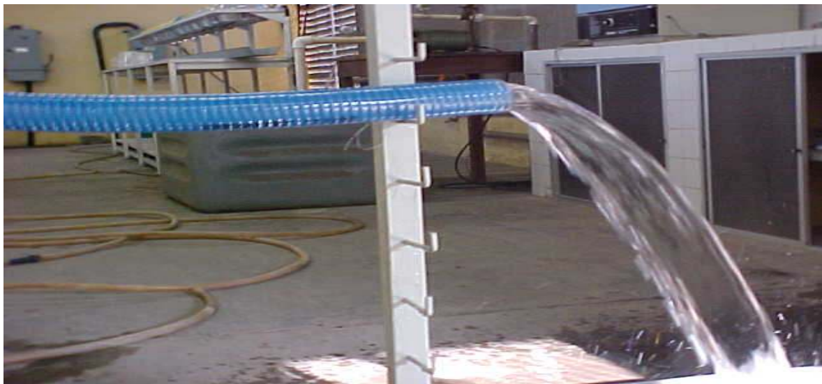
Figura 05. Procedimento para calibração de sifões em laboratório
