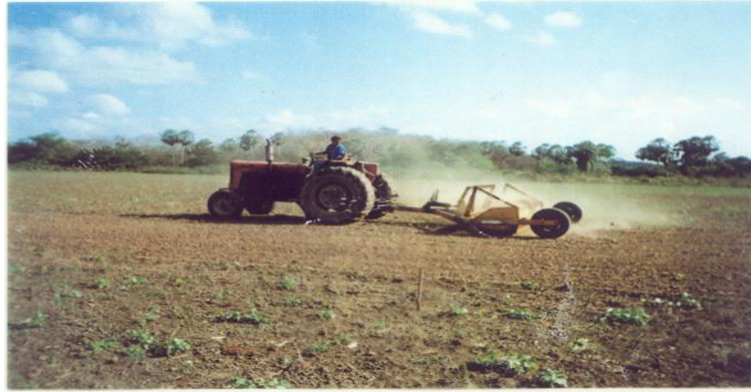
Figura 03. Sistematização de um terreno para irrigação.
